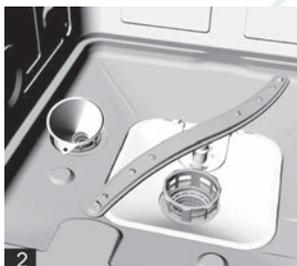
А. Извлеките нижнюю корзину, а затем откройте и снимите крышку с контейнера для соли. **1**
